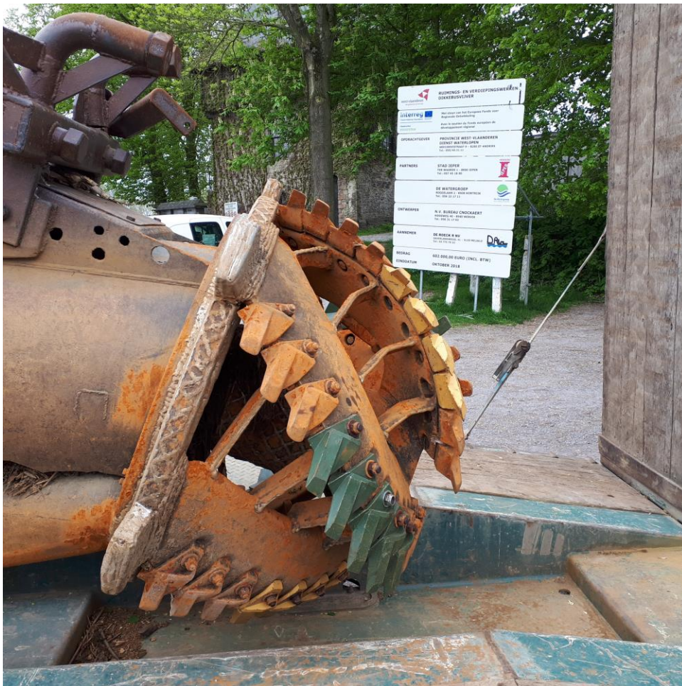
Photo m : Sous la surface de l'eau un trépan, monté sur la proue de la drague, aspire le sédiment mélangé d'eau et le propulse vers le bassin de traitement des boues.
